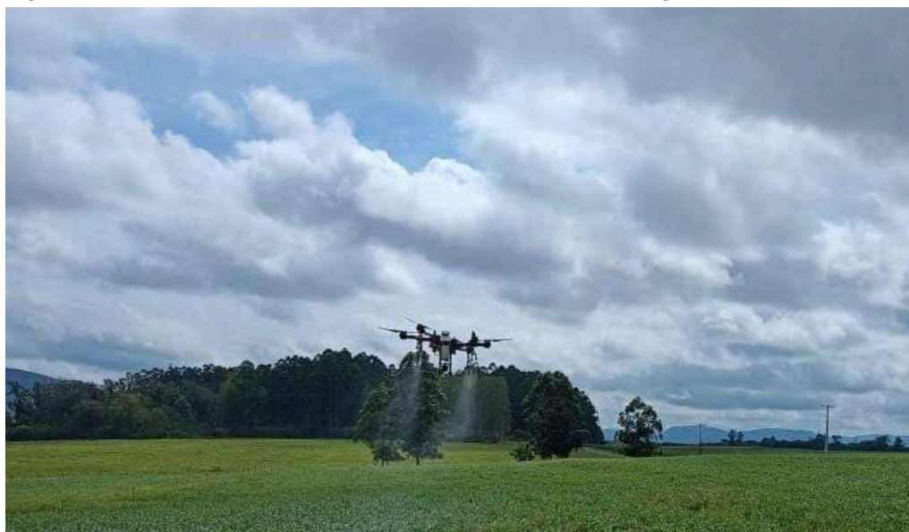
Figura 2. Aplicação de Azospirillum brasilense com drone de pulverização na cultura do milho.
