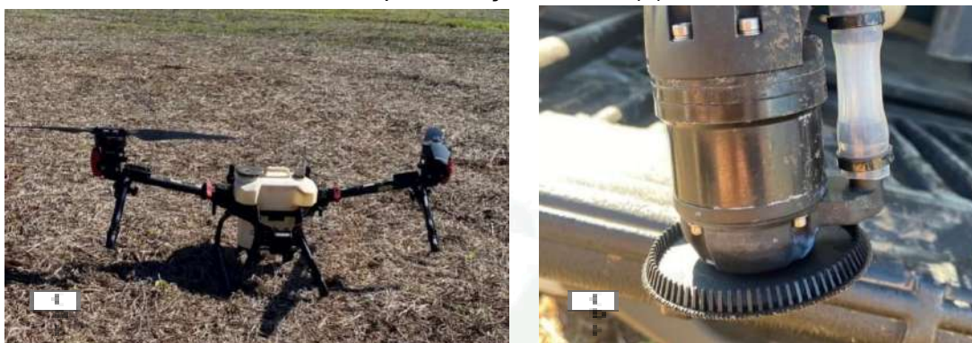
Figura 1. Drone da marca XAG modelo V40 (a) utilizado no experimento e detalhe da ponta de pulverização rotativa (b).
