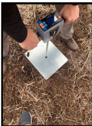
Figura 4 - Realização de amostragem de RP com o penetrômetro Falker, modelo penetroLOG PLG2040.
